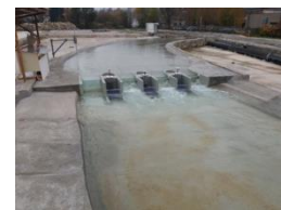
Fizični hidravlični model hidroelektrarne Vuzenica
