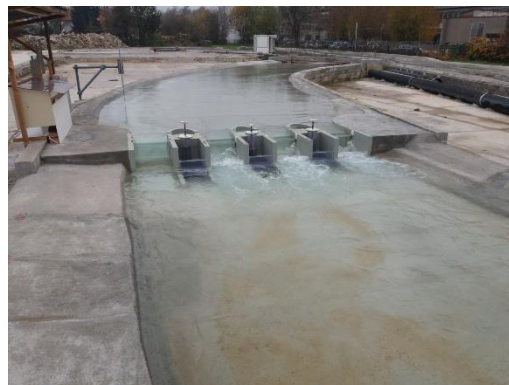
Fizični hidravlični model HE Vuzenica
