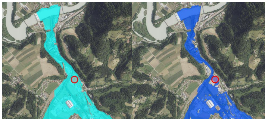
Slika 7: Območje poplav (desno 100 letne poplave in levo 500 letne poplave). Rdeč krog je mesto RTP Dravograd [5]
