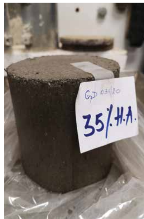
Slika 3: Prikaz testnega vzorca - kompozita (mešanica sedimenta iz Ptujkega jezera in apna)
